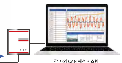
CAN으로부터 디코딩한 센서정보 Vector 제품 CANalyzer 표시 예
